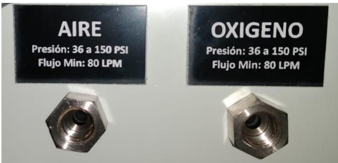
Figura 25. Conector con hilo hembra 1/4 NPT para entrada de aire y oxígeno
